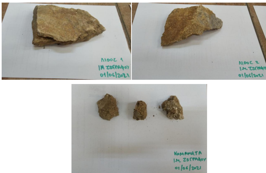
Εικόνα 20 Δείγματα λίθων και κονιαμάτων από το βορδοναρείο
