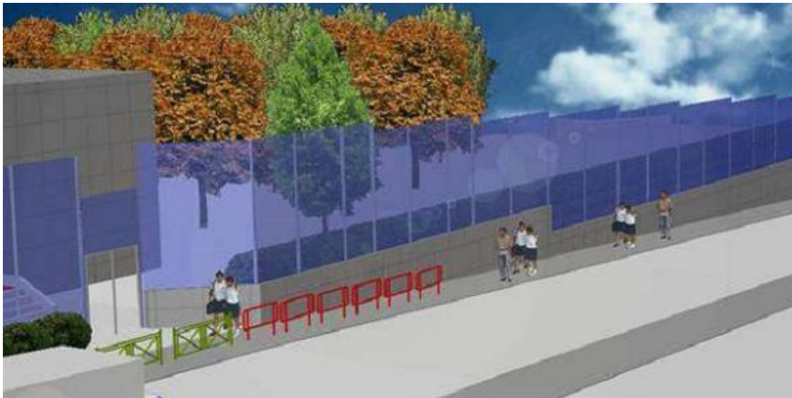
Εικόνα 6-1 Προσομοίωση τοποθέτησης ηχοπετάσματος σε σχολείο
