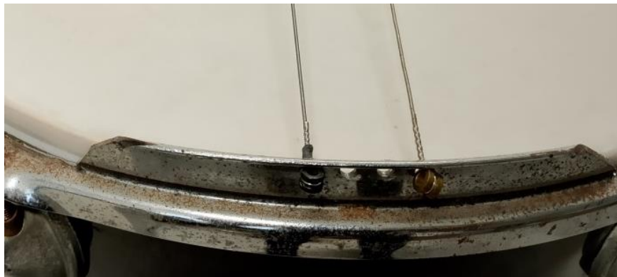
Εικόνα 3.5: Η μετατροπή του μεταλλικού στεφάνου (hoop) του floor tom σε ενεργό στοιχείο συγκράτησης των χορδών.
