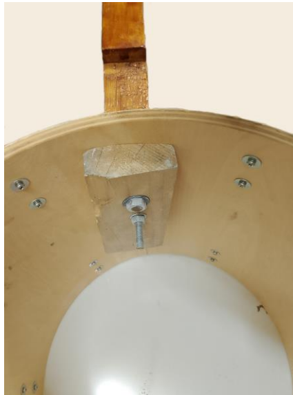
Εικόνα 3.6: Λεπτομέρεια της ειδικά διαμορφωμένης καμπυλωτής ξύλινης πλάκας (τάκος) για την έδραση και στατική σταθεροποίηση της ταστιέρας στο κυλινδρικό σώμα του Floor Tom.
