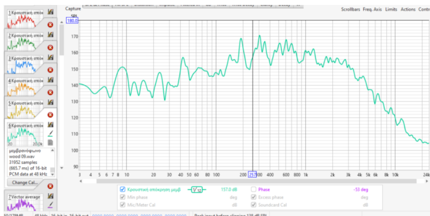
Εικόνα 5.33: Ανάλυση Απόκρισης Συχνότητας (SPL Analysis) για το δείγμα Wood Shell SPL 6.
