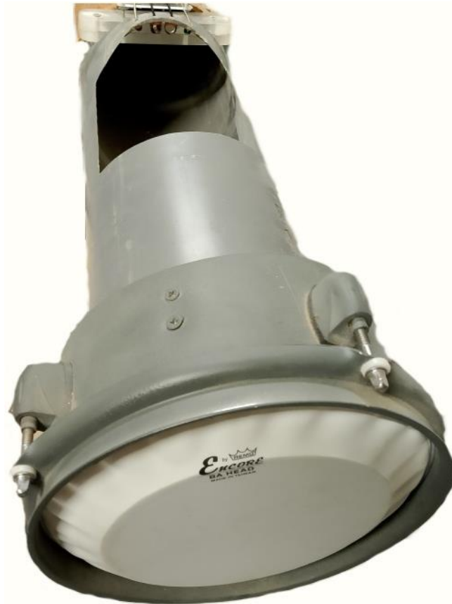
Εικόνα 3.11: Η μεμβράνη τύπου Encore εγκατεστημένη στο ελεύθερο άκρο του σωλήνα, λειτουργώντας ως δυναμικός παθητικός ακτινοβολητής.
