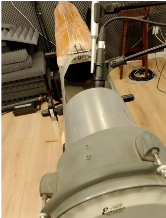
Εικόνα 4.3: Λεπτομέρεια της μικροφωνικής διάταξης (ECM8000 και SM57) για την ταυτόχρονη λήψη μετρολογικών και μουσικών δεδομένων.
