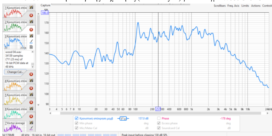
Εικόνα 5.30: Ανάλυση Απόκρισης Συχνότητας (SPL Analysis) για το δείγμα Wood Shell SPL 3.
