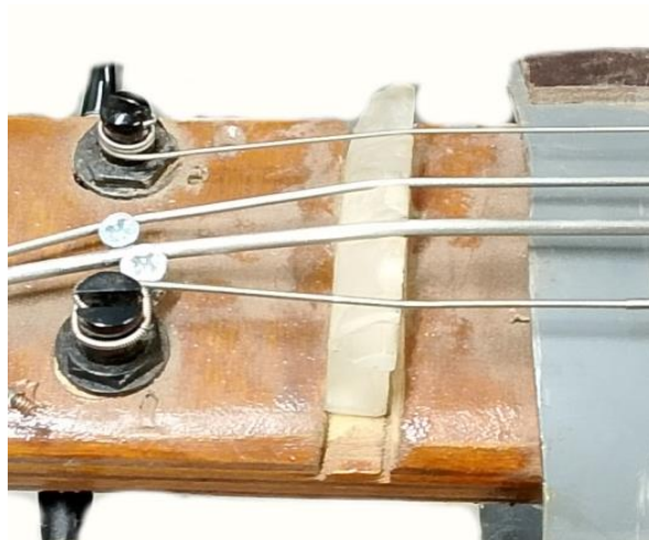
Εικόνα 3.8: Λεπτομέρεια της ακρυλικής γέφυρας (Plexiglas) και του σημείου έδρασης των χορδών πάνω στο σώμα από PVC, αναδεικνύοντας τη διαπαφή των διαφορετικών πολυμερών.
