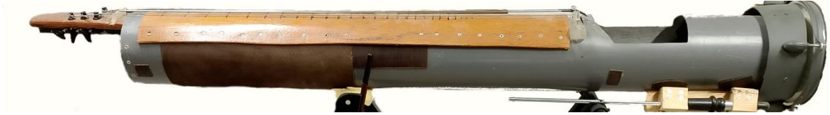
Εικόνα 3.2: Πλευρική όψη του οργάνου όπου φαίνεται η γραμμική δόμηση και η προσαρμογή της ξύλινης ταστιέρας πάνω στον κεντρικό φορέα από σκληρό PVC.
