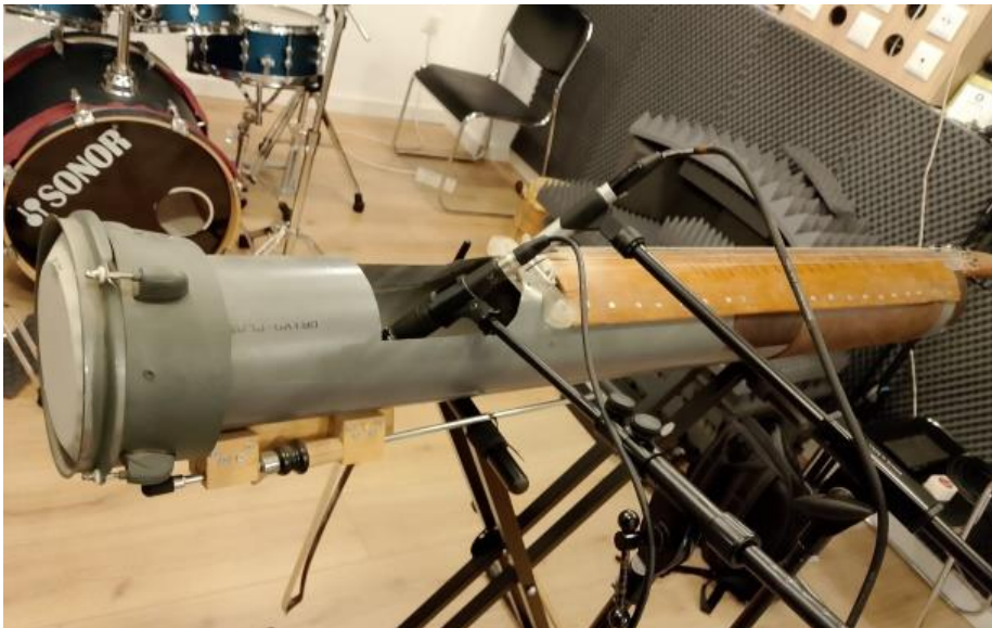
Εικόνα 4.1: Γενική άποψη της πειραματικής διάταξης στο στούντιο, όπου διακρίνεται η έδραση του PVC και η χωροθέτηση του εξοπλισμού.
