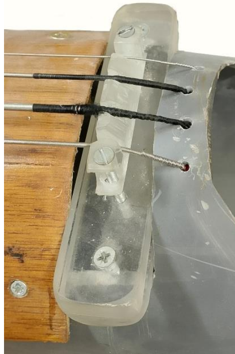
Εικόνα 3.7: Λεπτομέρεια του πίσω καβαλάρη (tailpiece/bridge) από Plexiglas.
