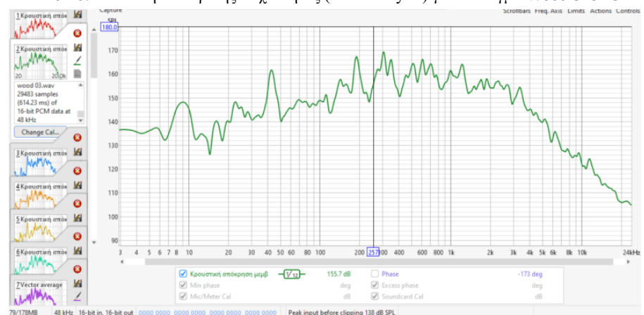
Εικόνα 5.29: Ανάλυση Απόκρισης Συχνότητας (SPL Analysis) για το δείγμα Wood Shell SPL 2.
