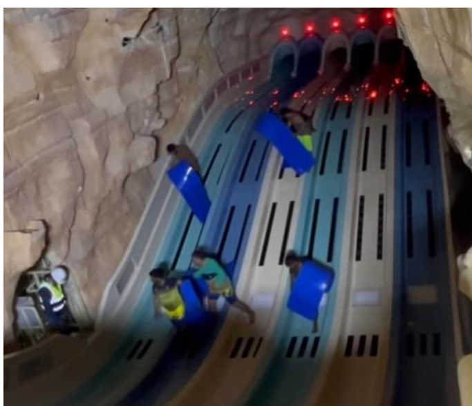
Εικόνα 20: Απεικόνιση δοκιμής εκκένωσης και ασφαλούς απομάκρυνσης χρηστών μετά την ενεργοποίηση του κομβίου κινδύνου (E-stop button).
