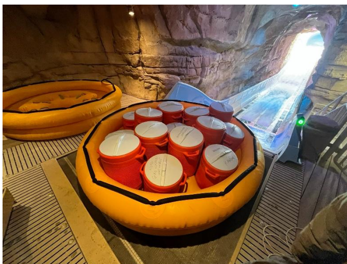
Εικόνα 18: Πραγματοποίηση δοκιμών υπέρβαρου με φορτία προσομοίωσης 10% άνω του ανώτατου επιτρεπόμενου ορίου βάρους, με χρήση πλαστικών βαρελιών νερού.
