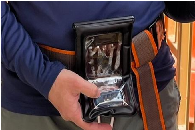
Εικόνα 19: Απεικόνιση τοποθέτησης οργάνου καταγραφής επιταχύνσεων σε δοκιμαστή κατά τις δοκιμές αποδοχής στο πεδίο (SAT)
