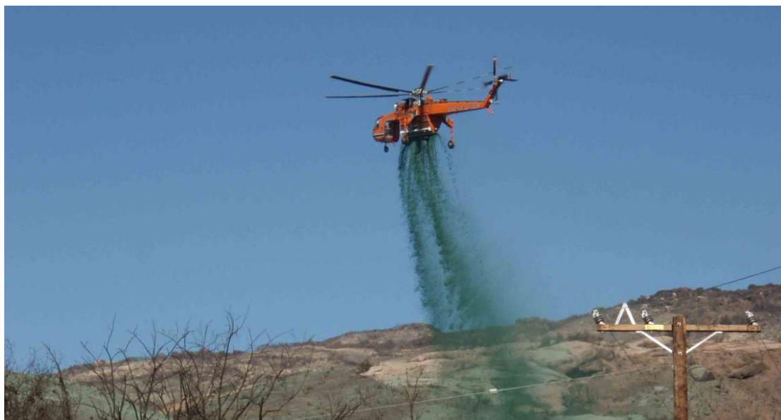
Εικόνα 44. Hydromulching με εναέρια μέσα (Πηγή: Air Force civil engineer center)
