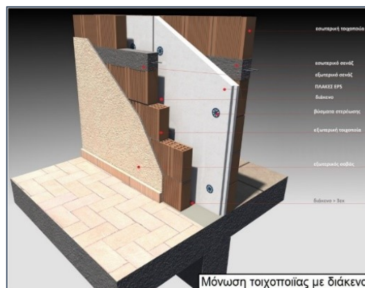
Εικόνα 38. Μόνωση τοιχοποιίας με διάκενο (ergatex, Επίσκεψη: 2021)
