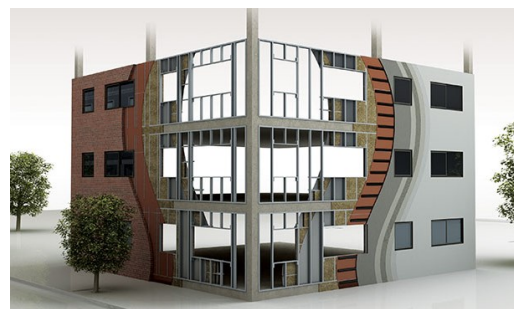
Εικόνα 56. Στρώμα θερμομόνωσης (Ventilated Façade Systems with light steel frame construction, Επίσκεψη: 2022) - Εικόνα 57. Ανάρτηση τελικής επιφάνειας (Iqbal, 2019)
