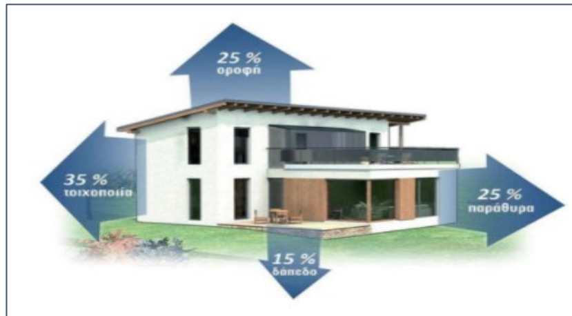
Εικόνα 26. Θερμικές απώλειες σε μία κατοικία (alunet.gr, 2019)
