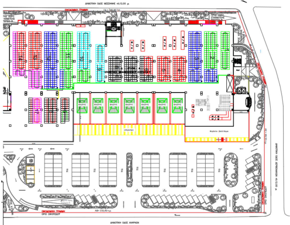
Εικόνα 1. Τοποθέτηση φωτοβολταϊκών πάνελ με κλίση 5 μοιρών σε υπαίθριο χώρο του καταστήματος
