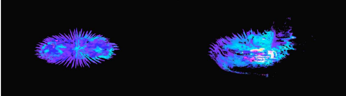
Εικόνα 17 : Ο τανυστής παραμόρφωσης σε προσαρμοσμένο map πάνω στα particles όπου κάθε χρώμα αποτελεί αναπαράσταση του διδυνάστατου πίνακα της παραμόρφωσης.
