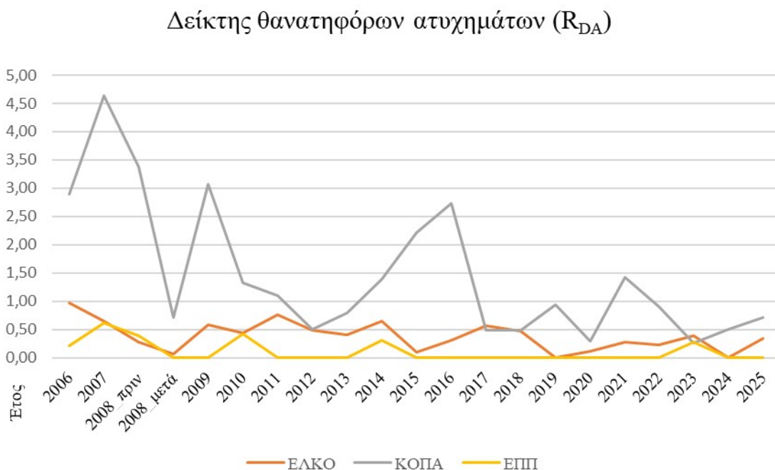
Σχήμα 23. Δείκτης θανατηφόρων ατυχημάτων R_i ανά 10^8 οχηματοχιλιόμετρα στην Ολυμπία Οδό
