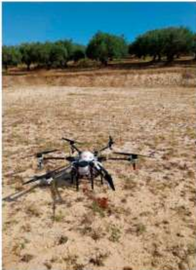
Εικόνα 3 Μη επανδρωμένο εναέριο όχημα (UAV, εξακόπτερο drone) που αξιοποιήθηκε σε ελαιώνα για εναέρια δολωματική εφαρμογή στο πλαίσιο της διαχείρισης του δάκου της ελιάς ( Bactrocera oleae ).
