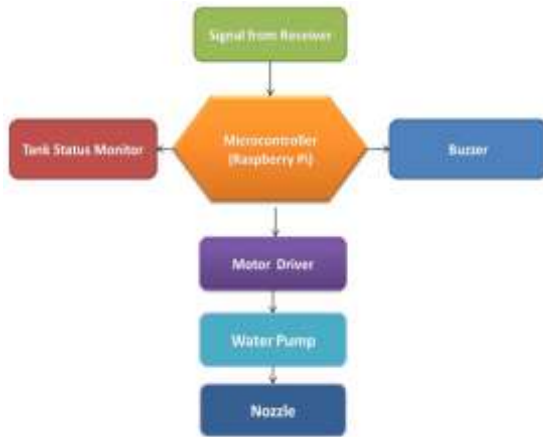
Εικόνα 4 Βασική αρχιτεκτονική συστήματος ψεκασμού με UAV, με μικροελεγκτή, οδηγό κινητήρα, αντλία και ακροφύσιο. Πηγή: Rahman et al. (2026).
