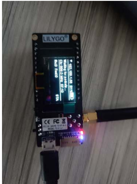
Σχήμα 30: Οθόνη OLED του LoRa Gateway κατά τη λειτουργία — ένδειξη WiFi, μπαταρίας, SF/RSSI και μετρητών Rx/Fwd.
