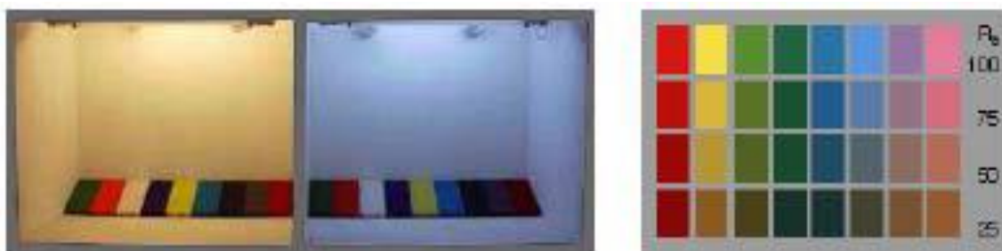
Εικόνα 1.6 Αριστερά: Ειδική διάταξη αξιολόγησης της χρωματικής απόδοσης του φωτισμού. Δεξιά: Χρώματα κάτω από φωτισμό διαφορετικών δεικτών χρωματικής απόδοσης. Πηγή: Μερέση 2010:62.
