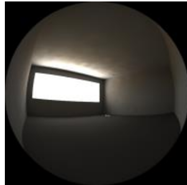
Πίνακας 9-3 Τυπική σχολική αίθουσα, με σύστημα σκίασης οριζόντιων περσίδων κλίσης 0^\circ , διαπερατότητας 0,20. Τιμές DGI και φωτορεαλιστική απεικόνιση εσωτερικού στο λογισμικό Radiance©. Πηγή: Προσωπικό αρχείο.
