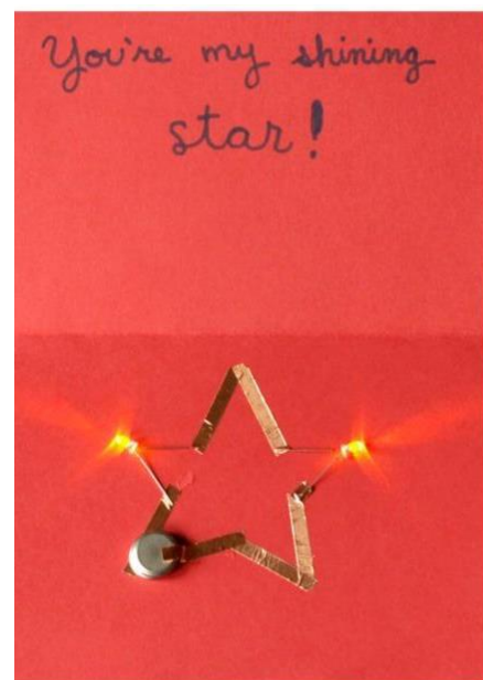
Εικόνα 33 Διαδραστική κάρτα και απλό ηλεκτρικό κύκλωμα
