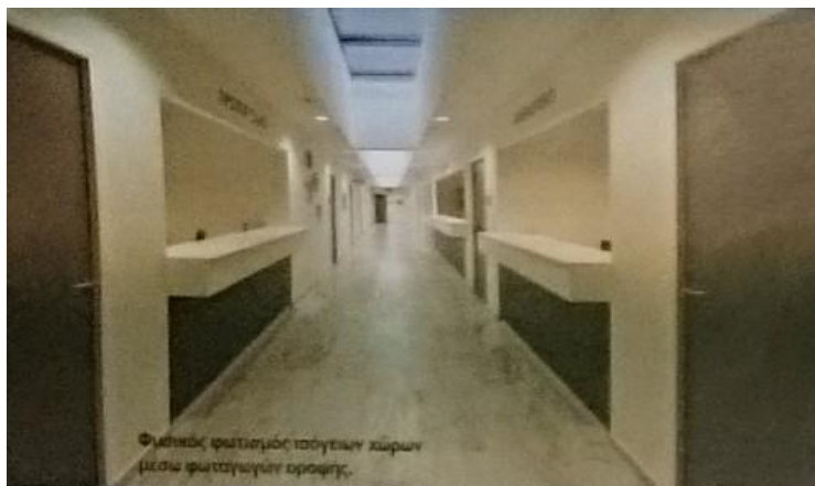
Εικόνα 2.1.3-1: Φυσικός φωτισμός διαδρόμων Δημαρχείου Κορυδαλλού μέσω φωταγωγών (πηγή: Potiropoulos, 2014)
