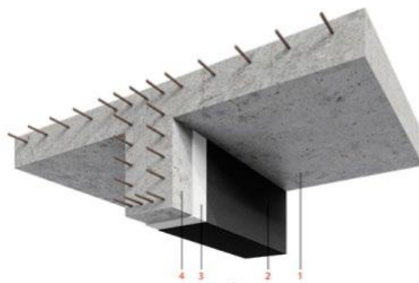
Σχήμα 5.19 Ενίσχυση Δοκού με FRP.
