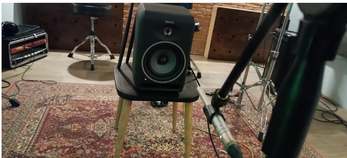
Εικόνα 4.9 Η δεύτερη on axis θέση σε απόσταση 1 μέτρου
