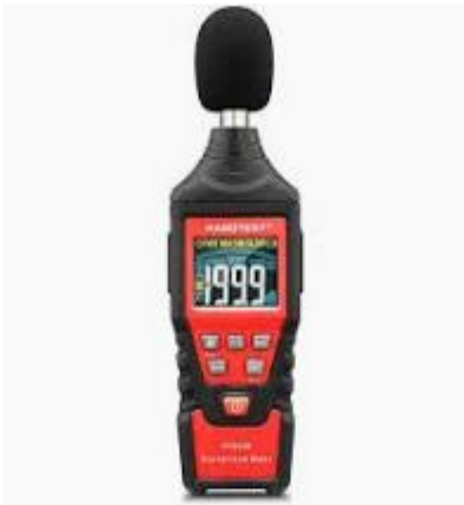
Εικόνα 4.19 Ο ψηφιακός μετρητής στάθμης Habotest HT622B που χρησιμοποιήθηκε στις μετρήσεις
