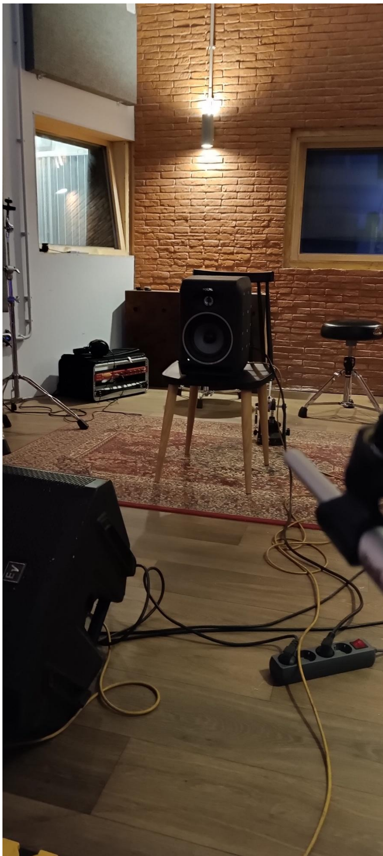
Εικόνα 4.12 Η πέμπτη διαγωνίως δεξιά off axis θέση στα 2 μέτρα
