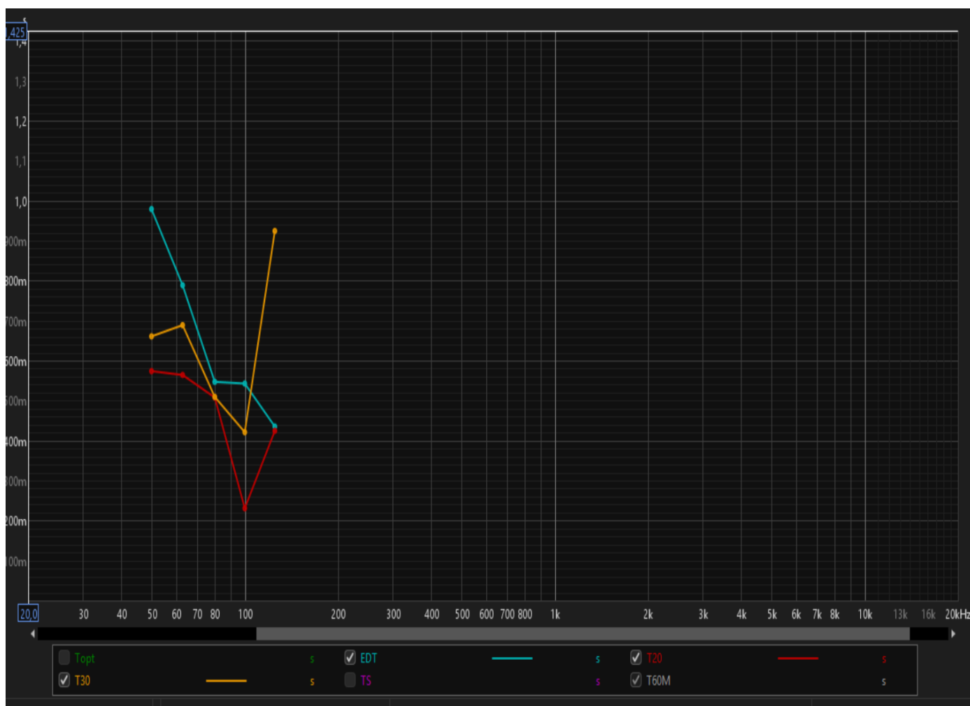
Εικόνα 4.40 Ο χρόνος αντήχησης για τη θέση 3 στα δεξιά του δωματίου από 20 έως 150 Hz
