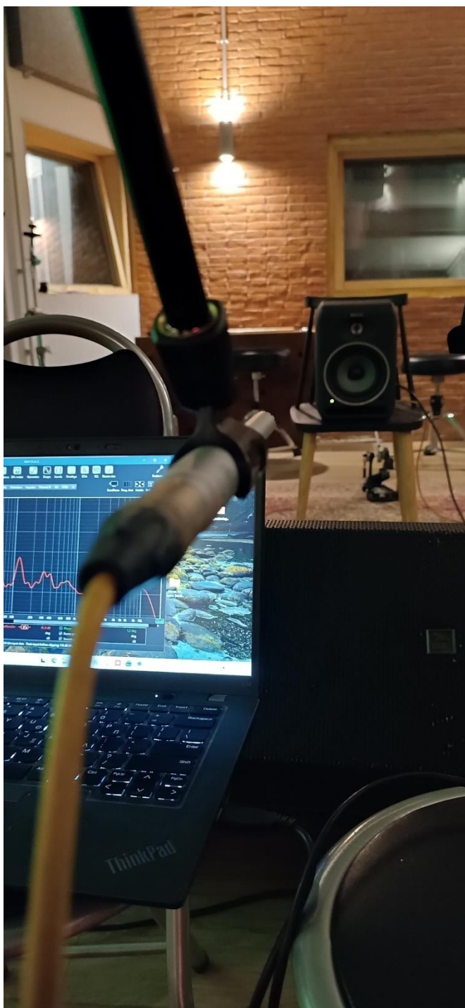
Εικόνα 4.10 Η τρίτη on axis θέση σε απόσταση 2 μέτρων
