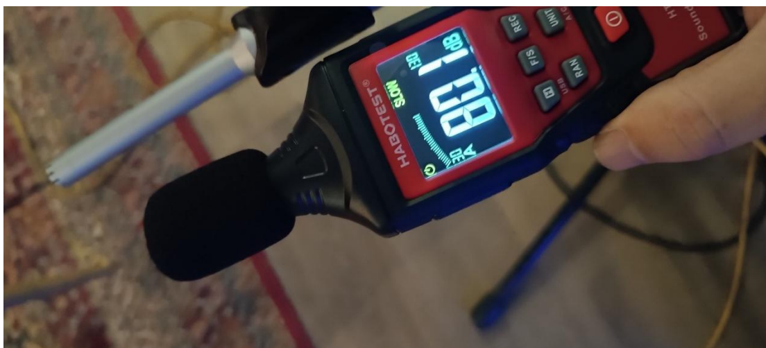
Εικόνα 4.8 Η μέτρηση στάθμης εξόδου του ηχείου στη θέση 1, 50 εκατοστά μπροστά από το ηχείο
