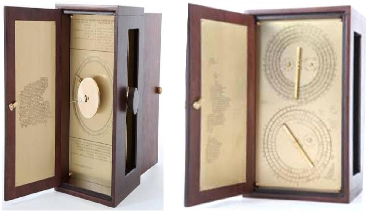
Εικόνα 5: Η πρόσθια και η οπίσθια όψη της λειτουργικής ανακατασκευής του Μηχανισμού των Αντικυθήρων (από αριστερά προς τα δεξιά)
