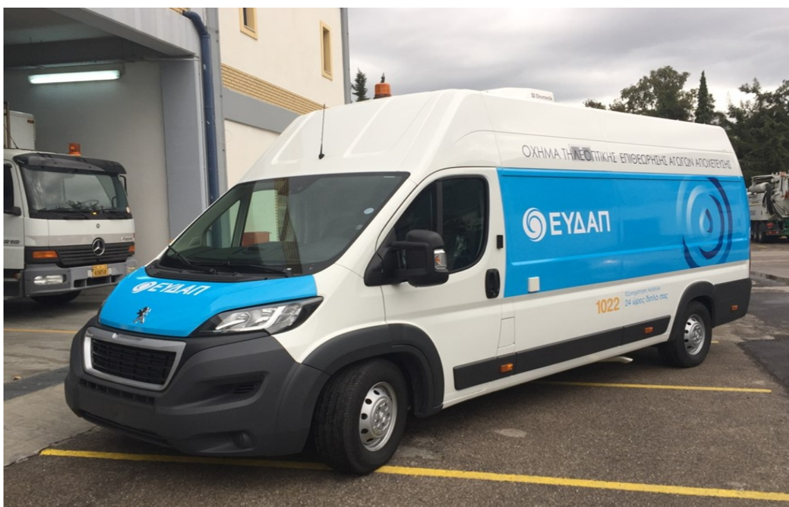
Σχήμα 12 Όχημα τηλεοπτικής επιθεώρησης αγωγών
