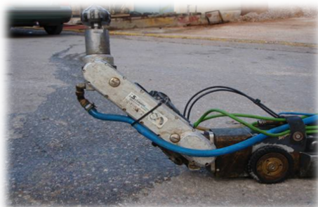
Σχήμα 38 Κεφαλή κοπής τσιμέντου αργίλου
