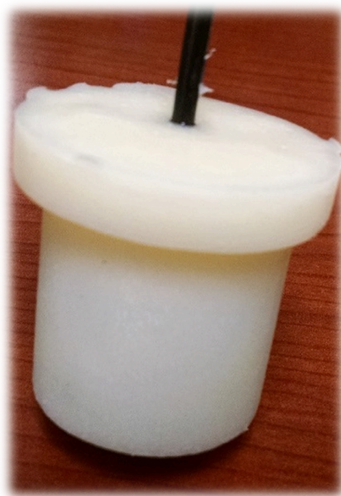
Εικόνα 50 Ένα ολοκληρωμένο υδρόφωνο. Η πολυουρεθάνη έχει χρώμα λευκό. Ωστόσο, με την πάροδο του χρόνου, όταν εκτίθεται σε υπεριώδες φως, το καουτσούκ μετατρέπεται σε πιο σκούρο καφέ. (Andrew Gray,2018)
