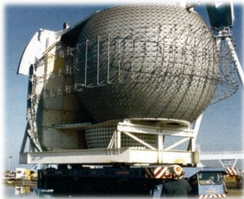
Εικόνα 42 Πλωραία κεραία sonar υποβρυχίου τύπου Seawolf SSN-21 (Ανακτήθηκε την 29/5/21 από: https://www.e-telescope.gr/en/science/science-misc/basic-concepts-in-submarines-evolution )
