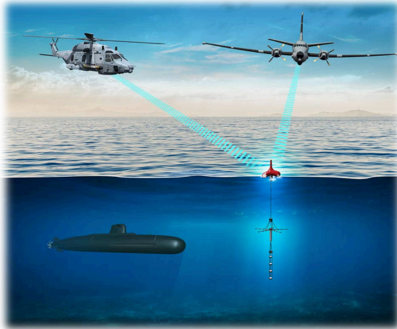
Εικόνα 46 Λήψη επαφής υποβρυχίου από παθητικό ηχοσημαντήρα και μετάδοση στοιχείων μέσω πομπού RF σε ιπτάμενα μέσα (Ανακτήθηκε την 11/8/21 από: https://www.navalnews.com/naval-news/2021/03/catching-ever-stealthier-submarines-french-navy-to-get-new-sonobuoy-technology/ - prettyPhoto)
