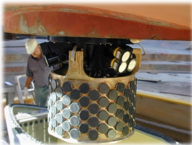
Εικόνα 34 Hull Mounted Sonar (Ανακτήθηκε την 23/5/21 από: https://www.thalesgroup.com/en/markets/defence-and-security/naval-forces/underwater-warfare/bluescan/hull-mounted-sonars )
