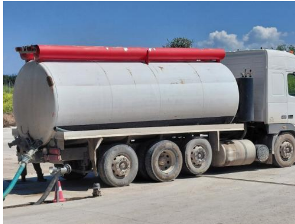
Εικόνα 19 - Άντληση υγρού χωνεμένου υπολείμματος από τη μεγάλη λιμνοδεξαμενή μέσω βυτίου της μονάδας προς διάθεση σε γειτονικούς αγρούς (προσωπικό αρχείο, 06/04/2026)
