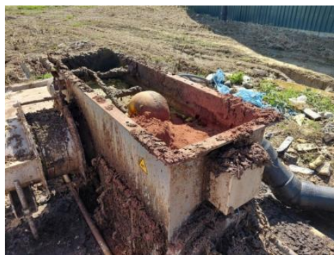
Εικόνα 14 - Μέθοδος αποθείωσης μέσω προσθήκης οξειδίων του σιδήρου (προσωπικό αρχείο, 06/04/2026)
