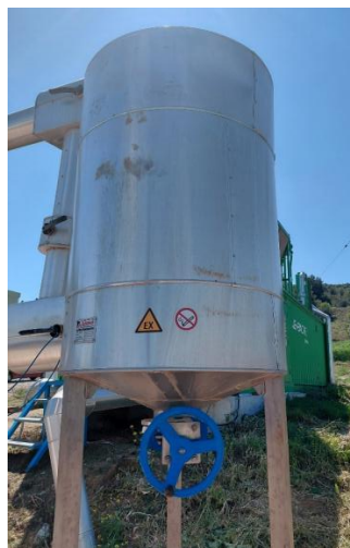
Εικόνα 15 - Φίλτρο ενεργού άνθρακα (προσωπικό αρχείο, 06/04/2026)
