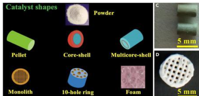
Εικόνα 1 - Καταλύτες διάφορων σχημάτων που χρησιμοποιούνται στην αναμόρφωση βιοαερίου (Zhao et al., 2020)
