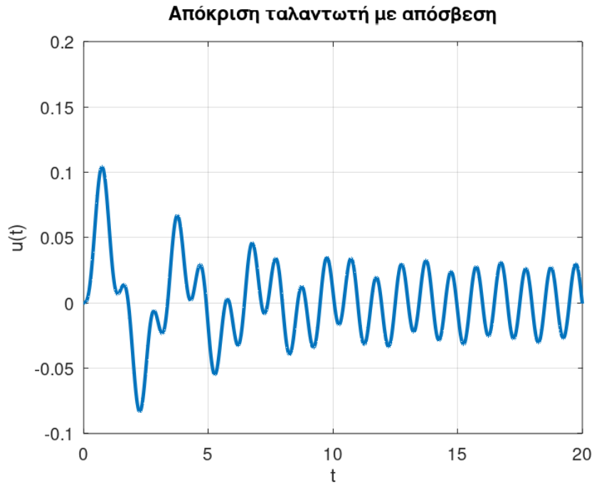
Σχήμα 5.15: Απόκριση μηχανικού ταλαντωτή με απόσβεση.
