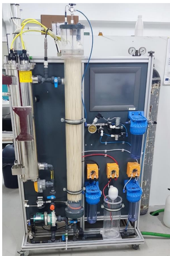
Εικόνα 3.3. Πιλοτικό σύστημα ετερογενούς φωτοκατάλυσης, συζευγμένης με μεμβράνες υπερδιήθησης κοίλων οινών (PMR), από τις εγκαταστάσεις του ΕΦΕΜ, ΕΚΕΤΑ.
