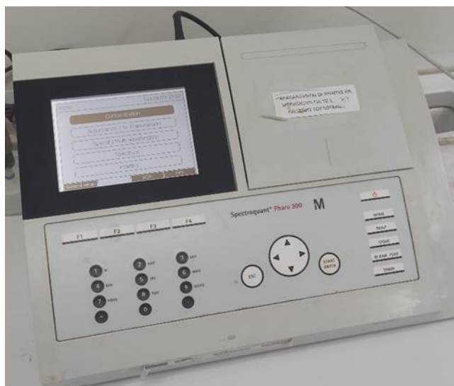
Εικόνα 5.1. Φωτόμετρο τύπου Pharo 300 Spectroquant.
