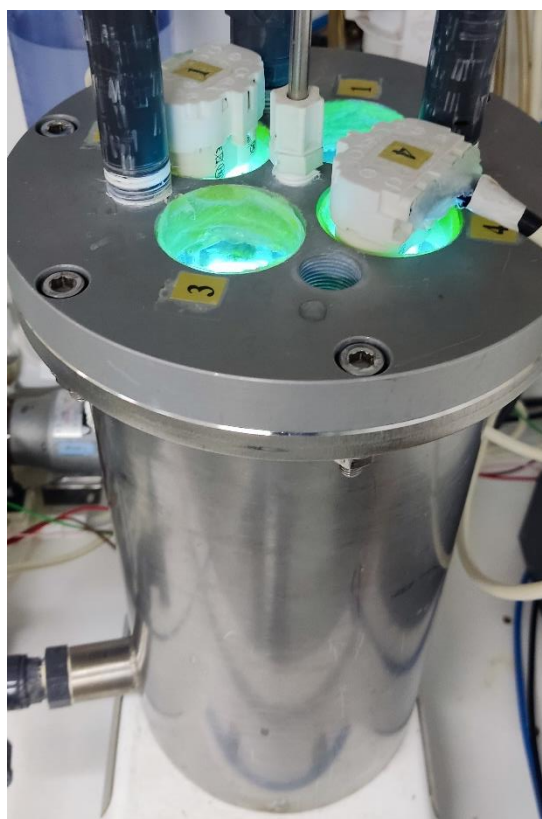
Εικόνα 5.6. Μονάδα φωτοκαταλυτικών και φωτολυτικών Προηγμένων Οξειδωτικών Μεθόδων Αντιρρύπανσης.
