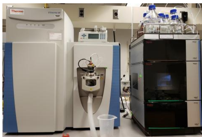
Εικόνα 5.3. Σύστημα υγρής χρωματογραφίας MS/MS, τύπου Q Exactive™ Focus Orbitrap, της εταιρείας Thermo Fisher Scientific.
