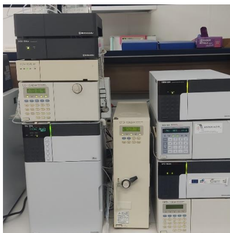
Εικόνα 5.2. HPLC τύπου CBM-20A, με ανιχνευτή Diode Array, της εταιρείας Shimadzu Europa GmbH.
