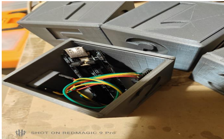
Εικόνα 31 - Εσωτερική διάταξη των ηλεκτρονικών του κύβου σε λειτουργική μορφή πρωτοτύπου
