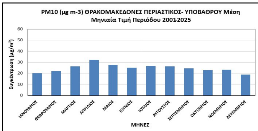
Διάγραμμα 35: Μέση εποχική και μέση μηνιαία διακύμανση των συγκεντρώσεων των \text{PM}_{10} , στο Σταθμό Περιαστικού Υποβάθρου, Αγ. Παρασκευή, την περίοδο 2001- 2025.
