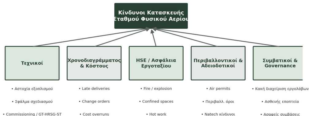
Σχήμα 5: Ταξινόμηση κινδύνων κατασκευής σταθμού φυσικού αερίου.
