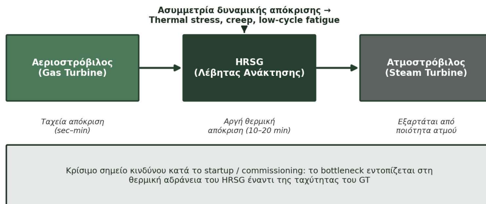
Σχήμα 6: Διεπαφή αεριοστροβίλου (GT) – HRSG – ατμοστροβίλου (ST) και ασυμμετρία δυναμικής απόκρισης.
