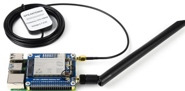
Εικόνα 10- LoRaWAN gateway της εφαρμογής.
