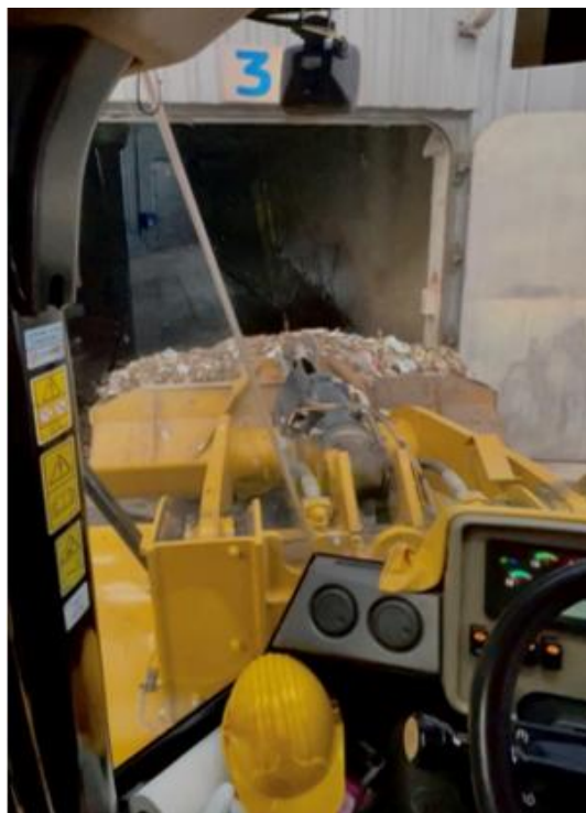
Εικόνα 5.2.7: Πλήρωση κελιού αναερόβιας χώνευσης.
