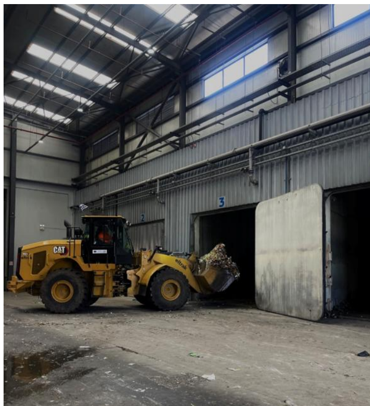
Εικόνα 5.2.6: Πλήρωση κελιού αναερόβιας χώνευσης με τη χρήση ελαστικοφόρου φορτωτή.
