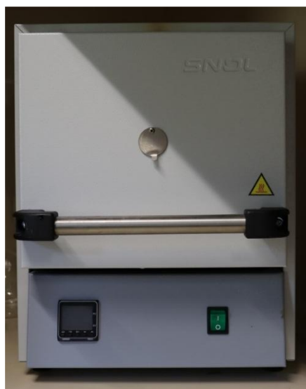
Εικόνα 5.3.3: Κλίβανος υψηλής θερμοκρασίας (550 °C).
