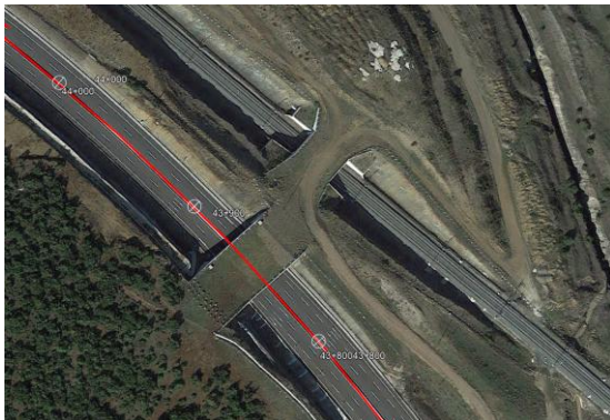
Εικόνα 7. Δίδυμη άνω διάβαση πανίδας (Ε65 με κόκκινη γραμμή και Νέα Σιδ/κή Γραμμή Υψηλών Ταχυτήτων). Περιοχή Ξυνιάδας (Χ.Θ.43,8).
