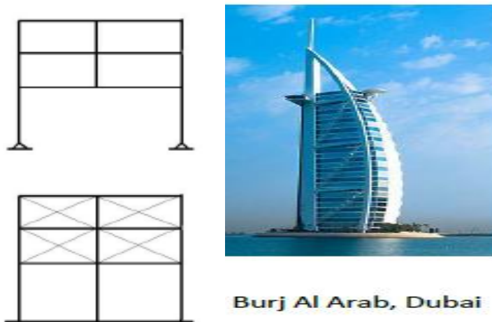
Εικόνα 2.1: Δομή άκαμπτου πλαισίου, κτίριο Burj Al Arab
