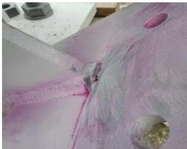
Εικόνα 3.5.2: Έλεγχος με τη μέθοδο των διεισδυτικών υγρών.
