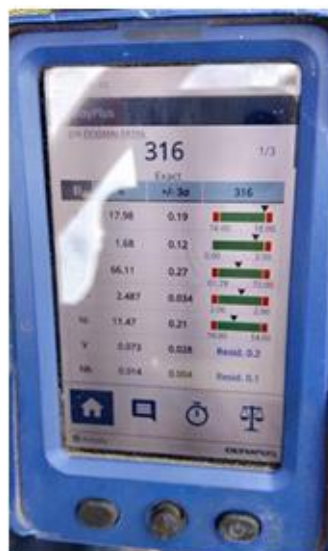
Εικόνα 6.1.5: Ενδείξεις οργάνου PMI μετρήσεων ανοξειδώτου χάλυβα τύπου 316
