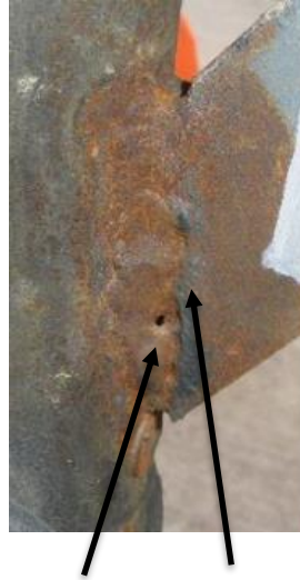
Εικόνα 3.4.2.1: Πόρος και ελλιπής συγκόλληση
