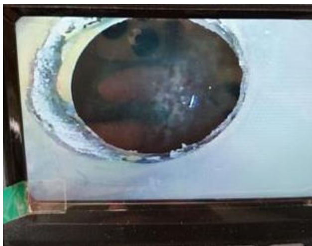
Εικόνα 3.5.1: Οπτικός έλεγχος με ενδοσκόπιο.
