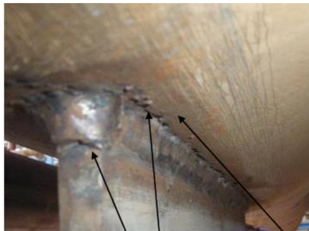
Εικόνα 3.4.2.1: Πόρος και ελλιπής συγκόλληση
