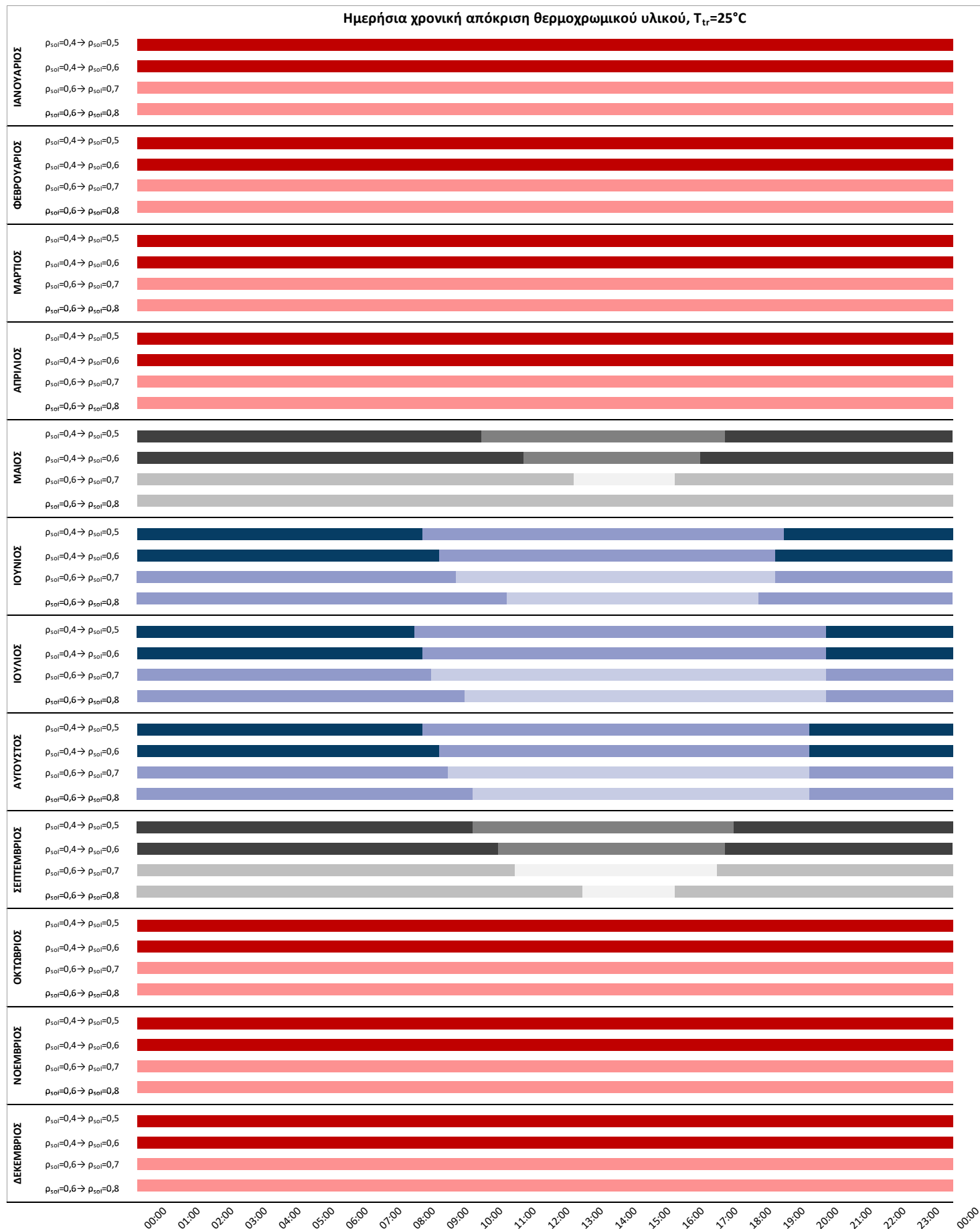
Σχήμα 4.1.1 Heatmap της χρονικής απόκρισης του θερμοχρωμικού υλικού για θερμοκρασία μετάβασης 25^{\circ}\text{C} .
