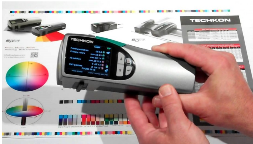
Εικόνα 74: Για οιαδήποτε υλοποίηση/εφαρμογή του προτύπου, ένα φασματοφωτόμετρο όπως το εικονιζόμενο, είναι απαραίτητο για τη μέτρηση των τιμών του χρώματος και του dot gain.
