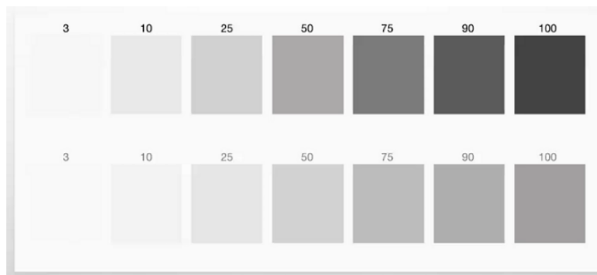
Εικόνα 79: Το TVI δεν ελέγχει και την τονικότητα. Στη διπλανή εικόνα, δείγματα ίδιου ονομαστικού ράστερ έχουν το ίδιο TVI, αλλά διαφορετική τονικότητα. Αυτό συμβαίνει γιατί το TVI είναι δείκτης αντανakλαστικότητας και όχι εμφάνισης.
