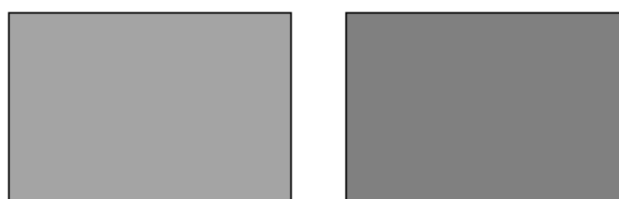
Εικόνα 29: 40% ράστερ στο αρχείο (αριστερά) με 16% dot gain, οδηγεί σε 56% ράστερ στην εκτύπωση (δεξιά) σε μία τυπική όφσσετ εκτύπωση
