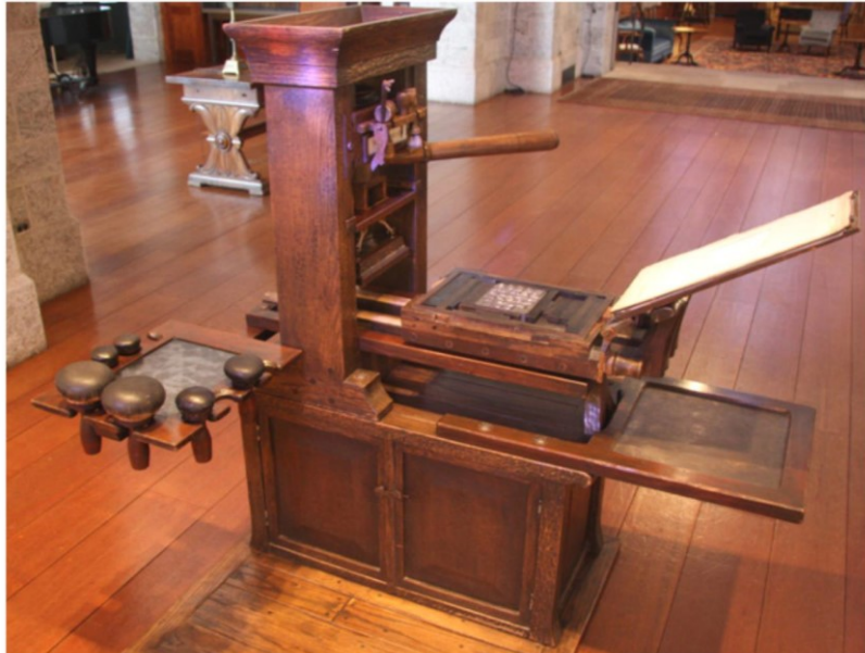
Εικόνα 9: Ξύλινη τυπογραφική μηχανή, αντίγραφο της μηχανής του Γουτεμβέργιου που εκτυπώνει περίπου 250 φύλλα την ώρα.
