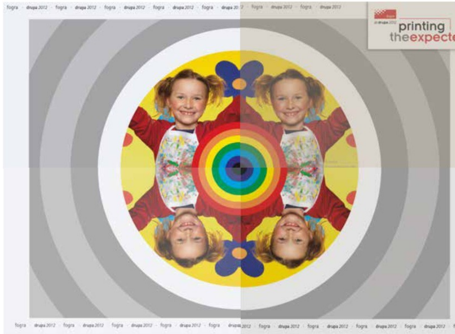
Εικόνα 55: Δοκιμαστική φόρμα εκτύπωσης σε τέσσερις διαφορετικές συνθήκες. Πηγή: Fogra 2019. Professional colour communication for multiprimary printing (ECG). [Online] Διαθέσιμο από: https://www.fogra.org/en/fogra-research/prepress/research-projects-prepress/multicolor--2-766/multicolor-printing.html
