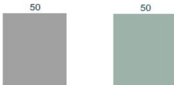
Εικόνα 101: Χρωματικά γκρι με ίδιο TVI, όμως διαφορετική απόχρωση Πηγή Debus Rick, n.d. G7 and Color Calibration Explained in Depth [Online]. Διαθέσιμο από https://www.signazon.com/g7-and-color-calibration-explained-in-depth.aspx
