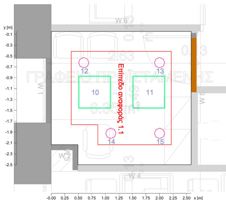
Εικόνα 101: Κάτοψη χώρου προσωπικού με τις ενδεικτικές θέσεις φωτιστικών σωμάτων.
