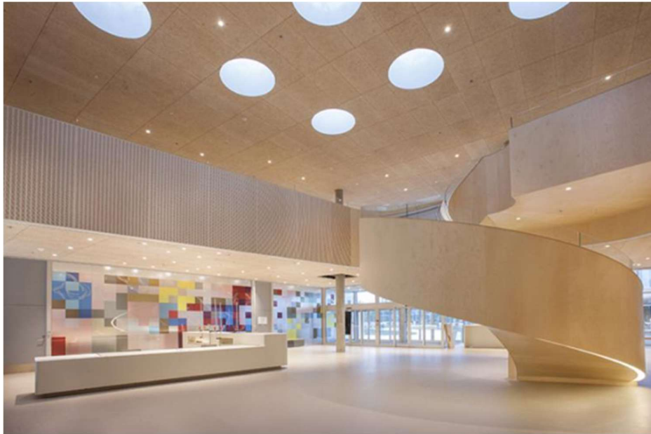
Εικόνα 53: Κοινόχρηστος χώρος στο Ψυχιατρικό Νοσοκομείο του Slagelse (Karlsson Architects & VLA). Το εγκατεστημένο δυναμικό σύστημα LED μεταβάλλει την ένταση και τη θερμοκρασία χρώματος κατά τη διάρκεια του εικοσιτετραώρου, αναπαράγοντας την πορεία του φυσικού φωτός για την υποστήριξη του κιρκάδιου ρυθμού των θεραπευόμενων. Πηγή: The Architectural Review (ανακτήθηκε 20/09/2026).
