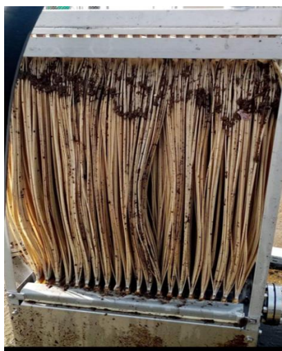
Εικόνα 3-4 Ρυπασμένο στοιχείο βιομεμβρανών
