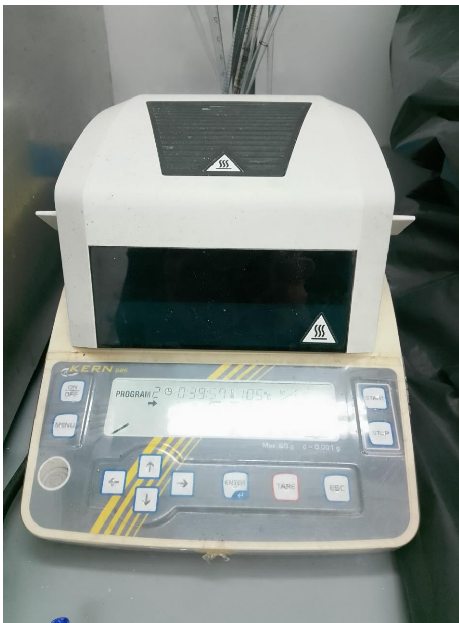
Σχήμα 2.10: Θερμοζυγός/εργαστηριακός εξοπλισμός ξήρανσης για φίλτρα.
