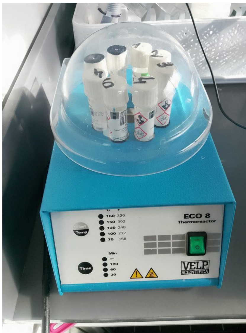
Σχήμα 2.5: Θερμοαντιδραστήρας VELP Scientifica ECO 8 και φιαλίδια για τον προσδιορισμό COD.
