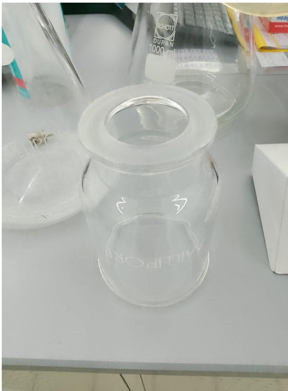
Σχήμα 2.9: Ξηραντήριο με silica gel για ψύξη φίλτρων πριν τη ζύγιση.
