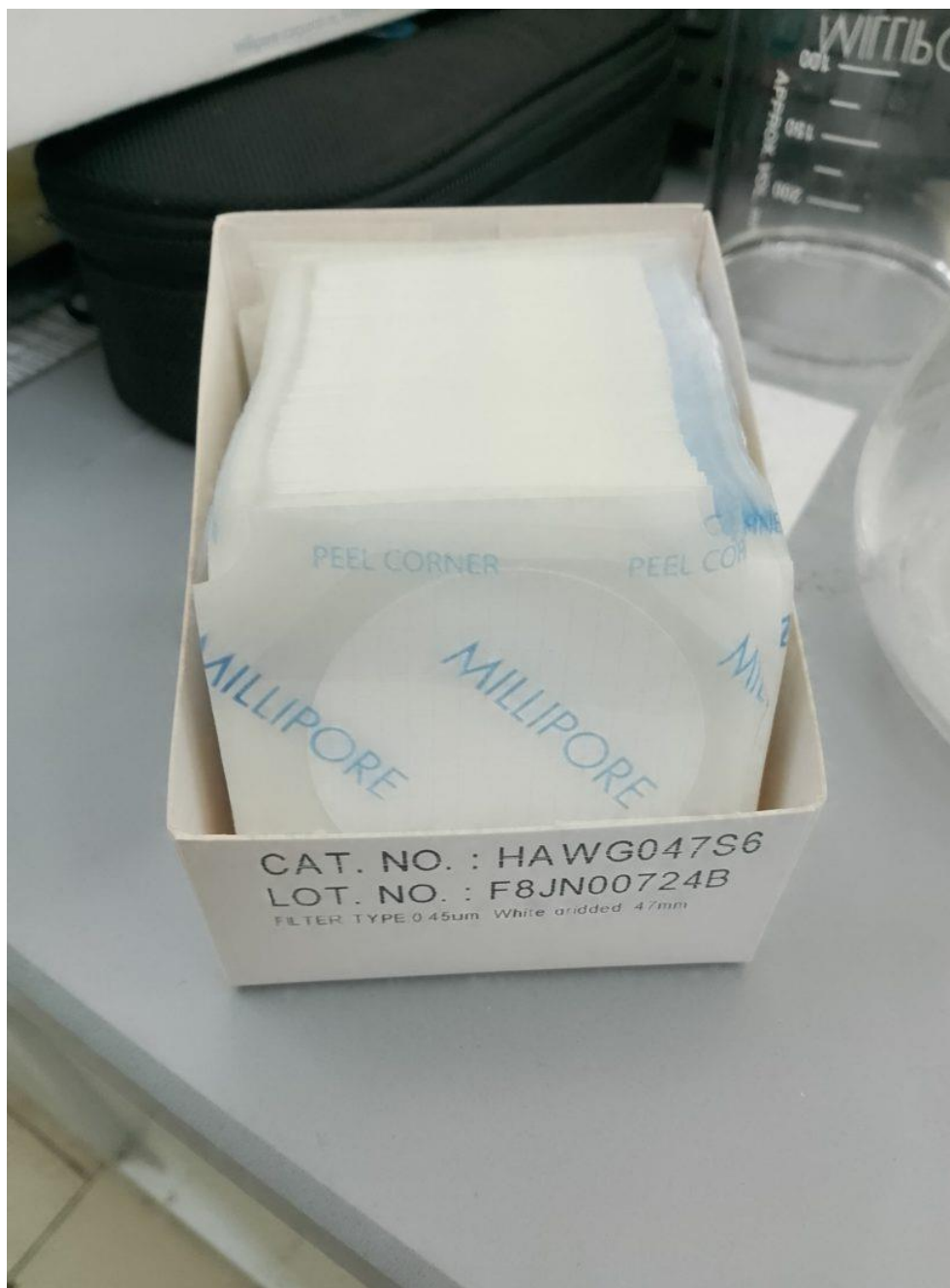
Σχήμα 2.7: Φίλτρα Millipore 0,45 \mu\text{m} για βαρυμετρικό προσδιορισμό αιωρούμενων στερεών.
