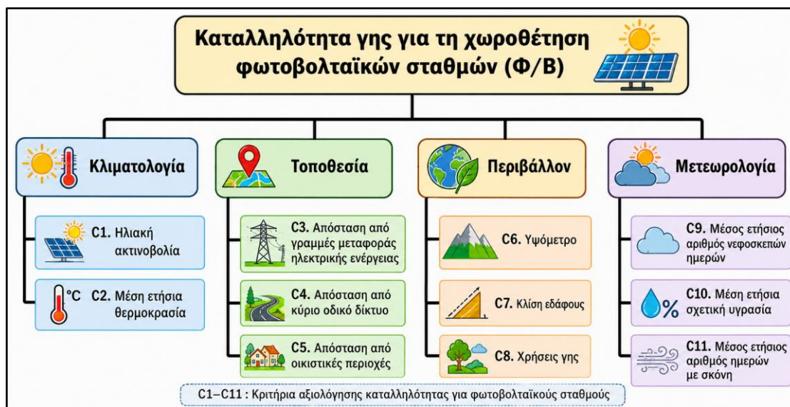
Εικόνα 9. Ιεραρχική δομή εφαρμογής της AHP για τη χωροθέτηση φωτοβολταϊκών σταθμών. Πηγή: Προσαρμογή από Noorollahi et al. (2016).
