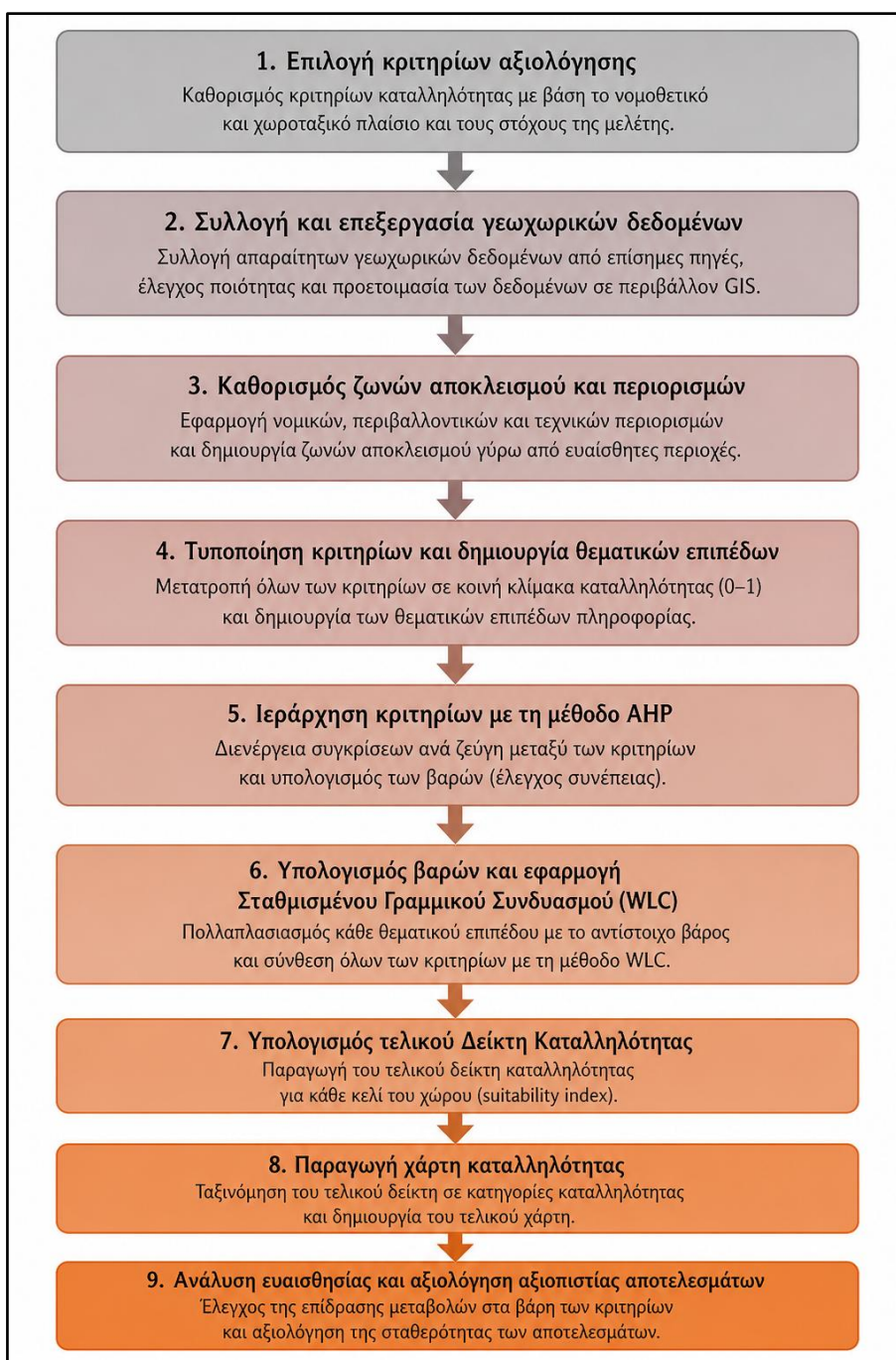
Εικόνα 13. Μεθοδολογικό διάγραμμα GIS–AHP–WLC της μελέτης
