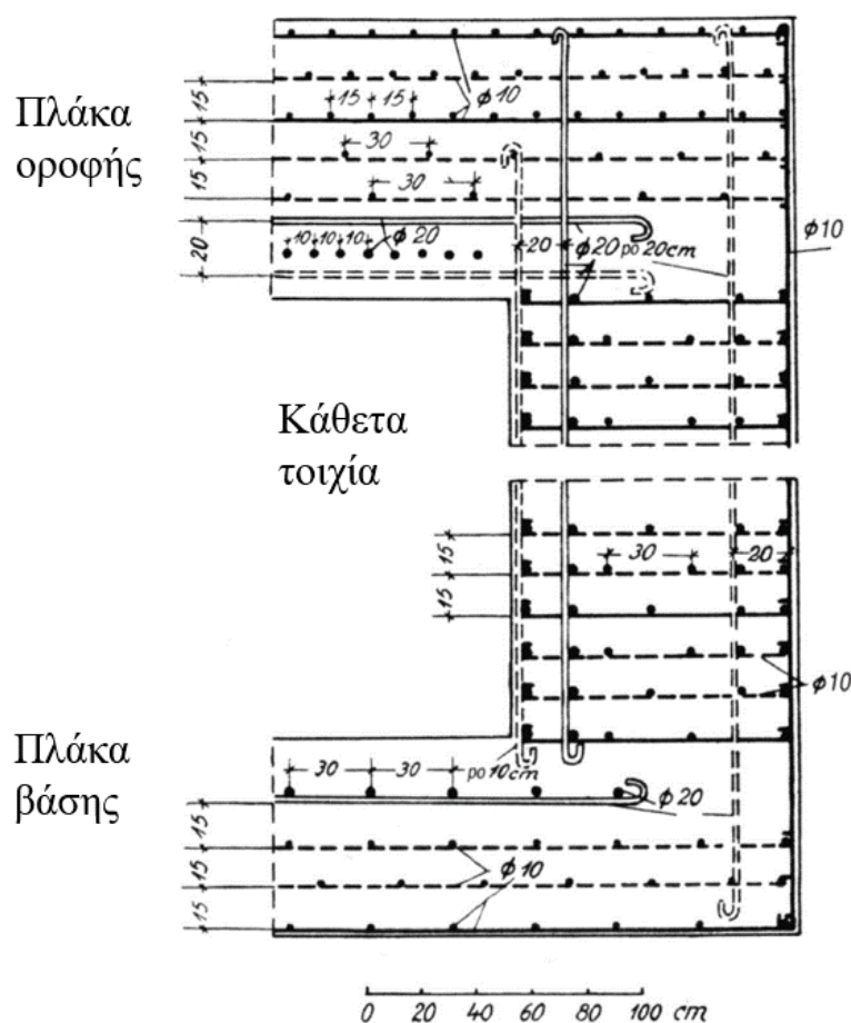
Σχήμα 6.2 Τυπική διατομή επιφανειακού έργου της Γραμμής Μεταξά (Πηγή: Kurka, 2001)
