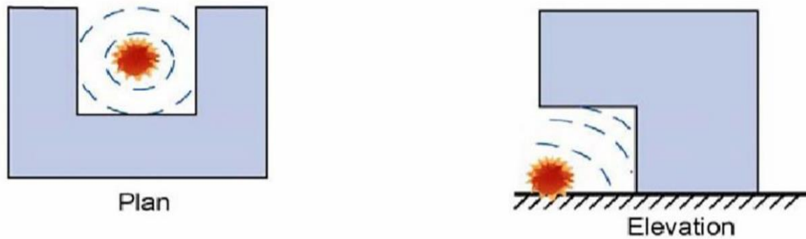
Σχήμα 2.5. Σχήματα κατασκευών που αυξάνουν την ισχύ του ωστικού κύματος (Πηγή: Anas et al, 2022)
