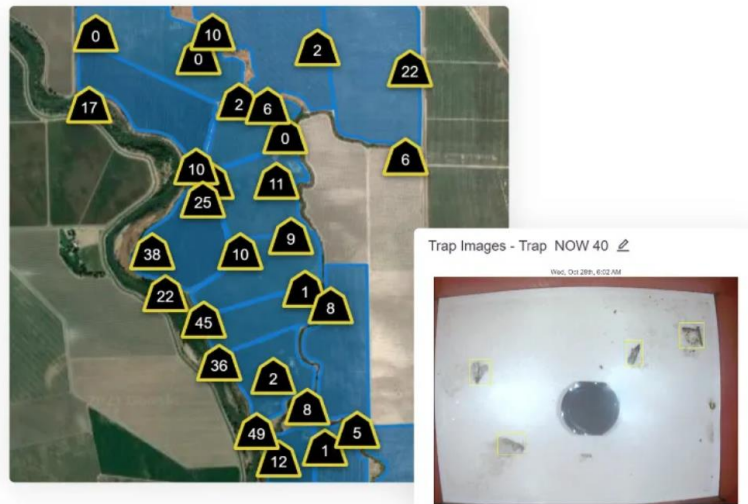
Εικόνα 4.1. Παράδειγμα αυτοματοποιημένου συστήματος οπτικών παγίδων της Semios για την παρακολούθηση εντομολογικών πληθυσμών σε δενδροκομικές καλλιέργειες, με ημερήσια καταγραφή εικόνων και αυτόματη καταμέτρηση εντόμων μέσω αλγορίθμων μηχανικής μάθησης και διαδικασιών εντομολογικής επαλήθευσης. Πηγή: https://semios.com/our-hardware/automated-camera-traps/?utm_source= με άδεια χρήσης από τον Robert Fifer της ομάδας Semios.
