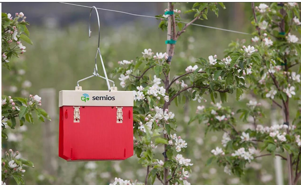
Εικόνα 2.5. Οπτική ηλεκτρονική παγίδα εντόμων εγκατεστημένη σε οπωρώνα, με ενσωματωμένο σύστημα καταγραφής και απομακρυσμένης παρακολούθησης για εφαρμογές γεωργίας ακριβείας και ολοκληρωμένης φυτοπροστασίας. Πηγή: https://semios.com/our-hardware/automated-camera-traps/ , με άδεια χρήσης από τον Robert Fifer της ομάδας Semios.
