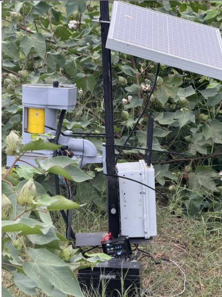
Εικόνα 2.4. Έξυπνη οπτική παγίδα εντόμων (sticky trap) εγκατεστημένη σε καλλιέργεια, εξοπλισμένη με κάμερα και αυτόνομη τροφοδοσία (ηλιακό πάνελ). Το σύστημα καταγράφει και μεταδίδει εικόνες για την αυτόματη ανίχνευση, καταμέτρηση και αναγνώριση εντόμων μέσω τεχνικών μηχανικής όρασης και μηχανικής μάθησης, συμβάλλοντας στη γεωργία ακριβείας και την αποτελεσματική εφαρμογή της Ολοκληρωμένης Αντιμετώπισης Εχθρών (IPM). Πηγή: https://4dfarm.org/research/2024/iot-smart-traps/ , με άδεια χρήσης από τον Glen C Rains, PhD
