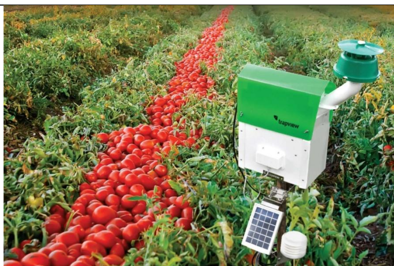
Εικόνα 3.1. Ενδεικτικό εμπορικό σύστημα ηλεκτρονικής παγίδευσης τύπου funnel με δυνατότητες τηλεμετρίας, ψηφιακής απεικόνισης και απομακρυσμένης παρακολούθησης πληθυσμών εντόμων σε συνθήκες αγρού. Πηγή: https://trapview.com/ , με άδεια χρήσης από Klemen Zevnik.
