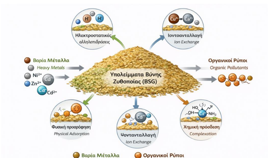
Σχήμα 2.3. Εννοιολογικό διάγραμμα μηχανισμών προσρόφησης ρύπων από BSG
