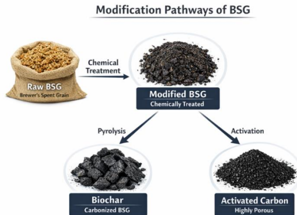
Σχήμα 2.4. Διαδρομές τροποποίησης BSG ( chemical treatment → biochar → activated carbon )
