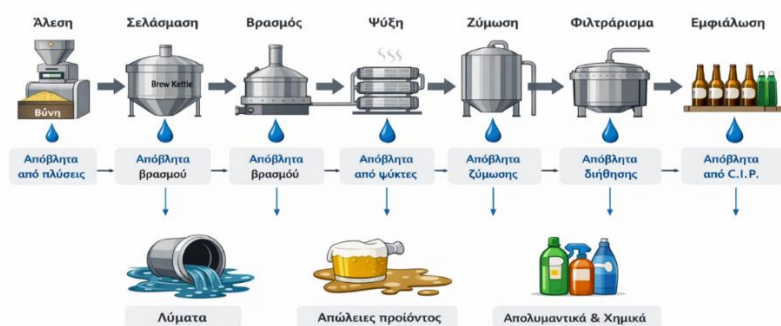
Σχήμα 2.1. Διάγραμμα σταδίων ζυθοποίησης και σημείων παραγωγής υγρών αποβλήτων
