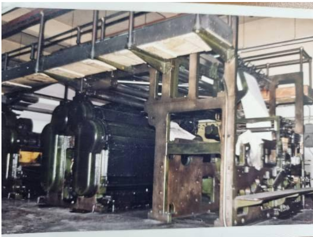
Το κυλινδρικό ταχυπιεστήριο της εφημερίδας Ταχυδρόμος (πλάγια όψη του πιεστηρίου)
