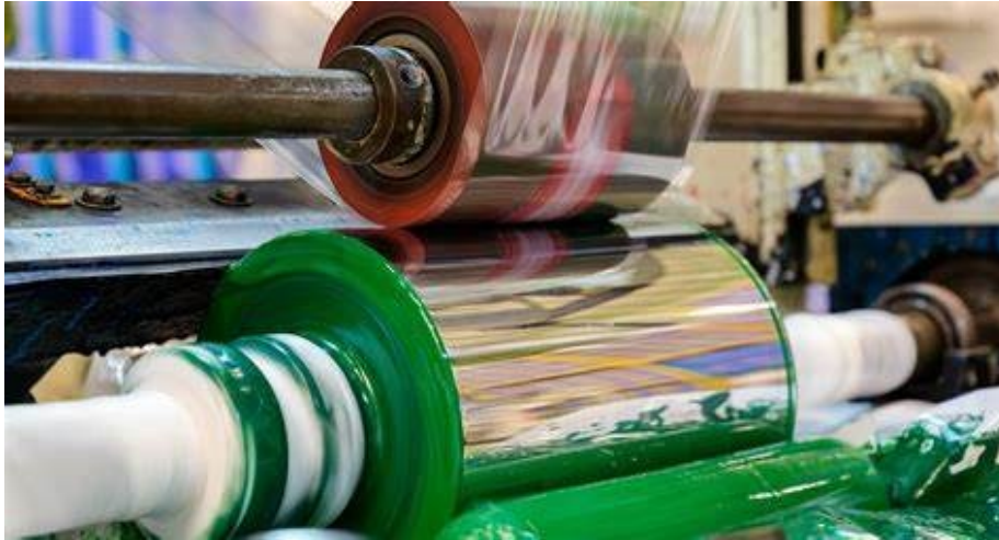
Εικόνα 40. Rotogravure Cylinder Printing Process
