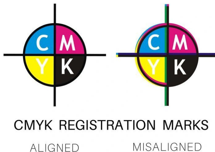
Εικόνα 42. Misregistration in Printing
