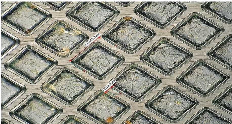
Εικόνα 57. Εγχάρακτη Επιφάνεια Κυλίνδρου - Μορφή Κουκίδας Χάραξης
