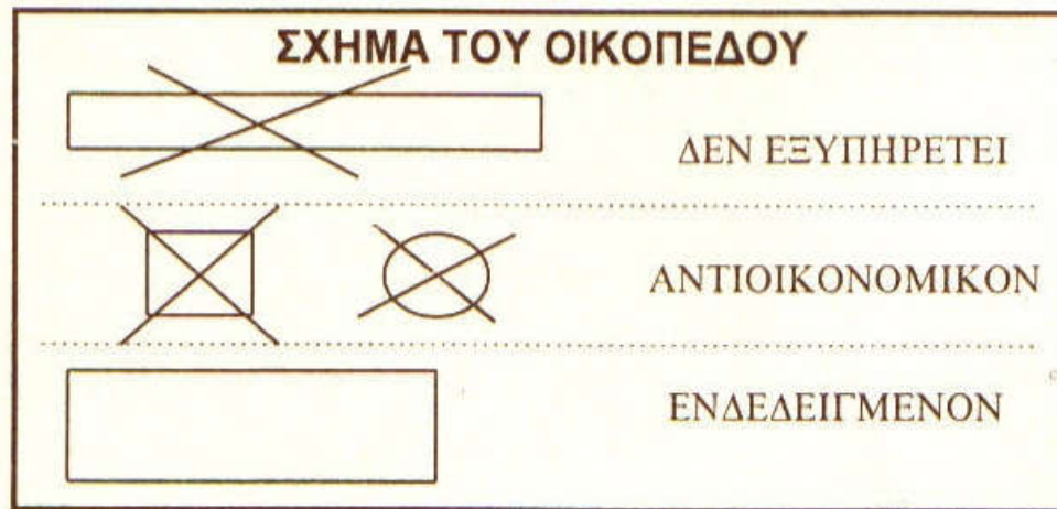
Εικόνα 7. Σχήματα οικοπέδων στρατιωτικών εγκαταστάσεων. (Πηγή: Μπάκας 1997, 7)
