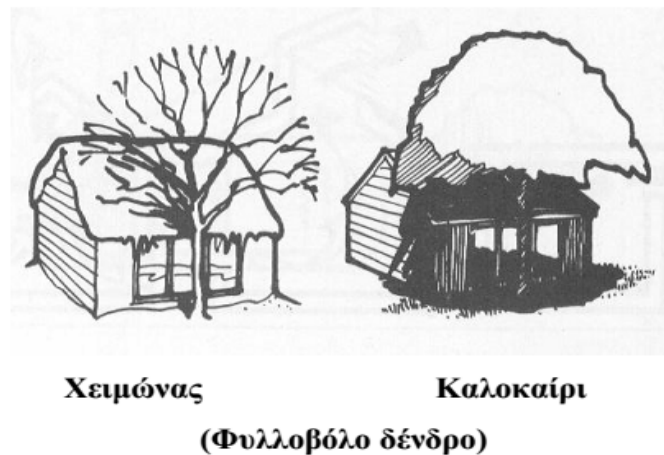
Εικόνα 12. Η πρακτική χρήση των φυλλοβόλων δένδρων τη θερμή και την ψυχρή εποχή του έτους. (Πηγή: Μαμαής-Σαργέντης 2002, 14)
