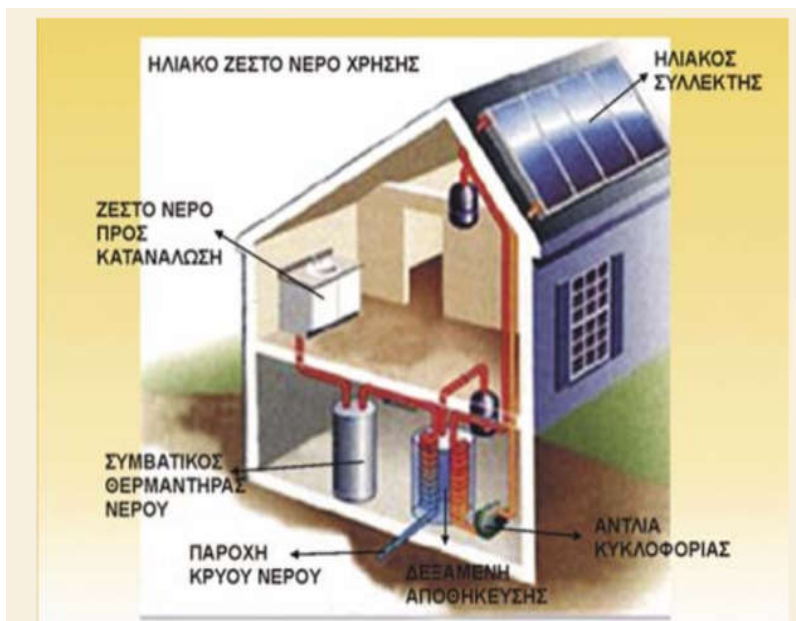
Εικόνα 22. Οικιακή εγκατάσταση για ZNX. (Πηγή: TRASOL Λογισμικό κατάρτισης στο τομέα των ηλιακών συστημάτων, μέσω ΚΑΠΕ χ.η.).
